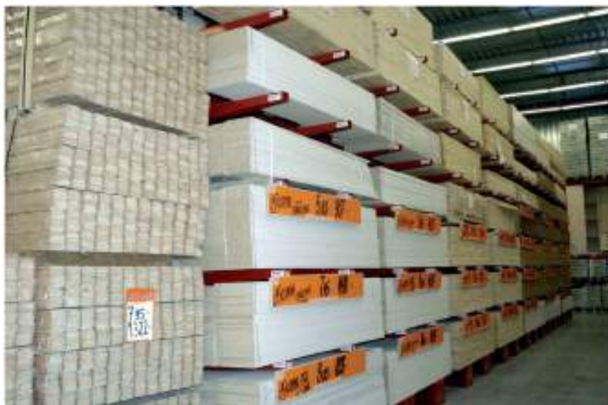
Cada estantería se subdivide en módulos, niveles y ubicación.
