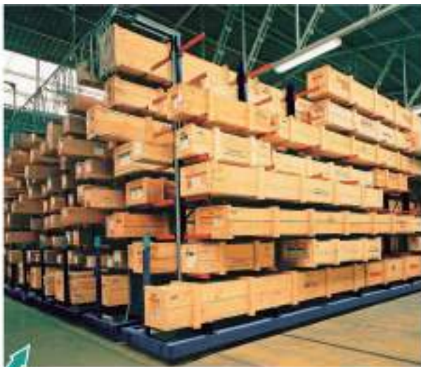
Almacenaje de cargas largas en estanterías cantilever.
