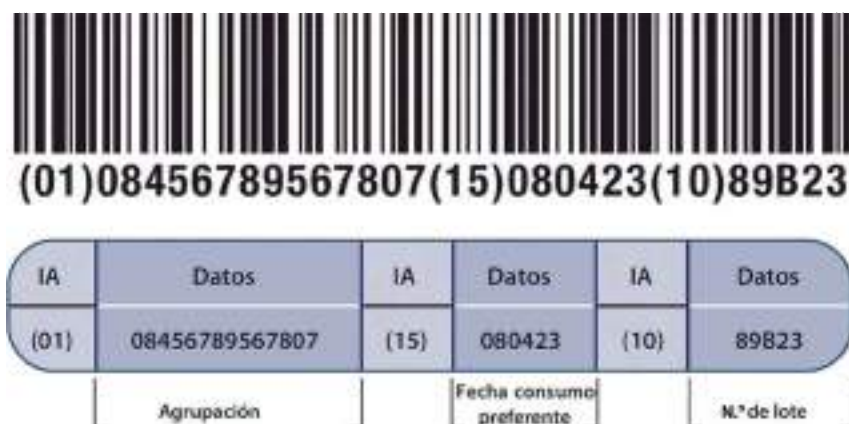
Figura 7.7. Estructura del código de barras del GS1-128. Fuente AECOC.
