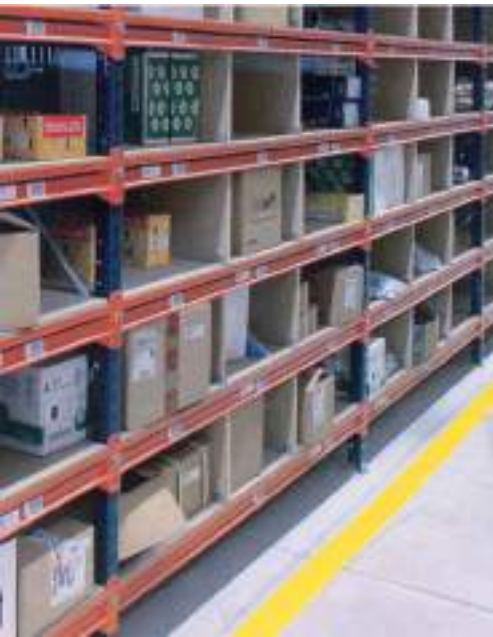
Estanterías diseñadas para picking . Ocupan toda la altura del almacén, pero cada hueco tiene una referencia.
