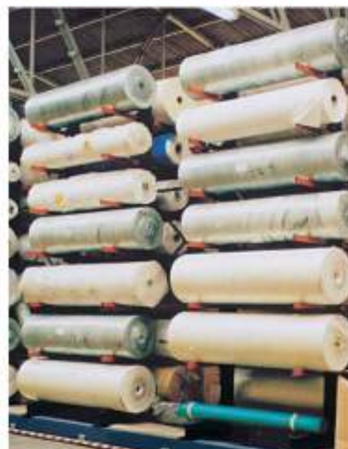
Cantilever para las bobinas de plástico laminado que se utiliza en invernaderos o para el retractilado de cargas.
