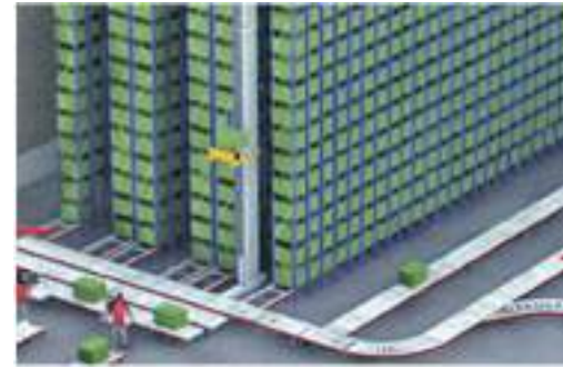
Almacén automático. Utiliza transportadores de rodillos y transelevadores.
