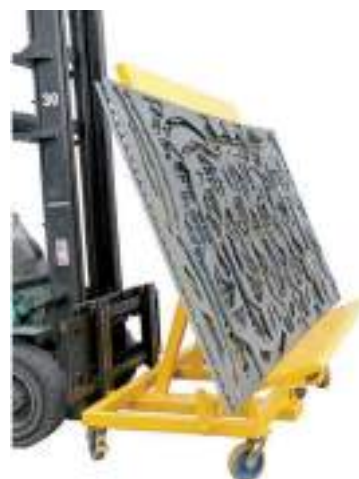
Caballete en forma de «A» para transportar placas de vidrio y amianto.
