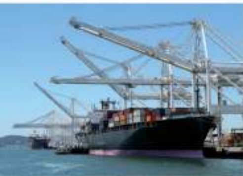
Grúas para la carga/descarga. Son medios que permanecen fijos en el puerto.
