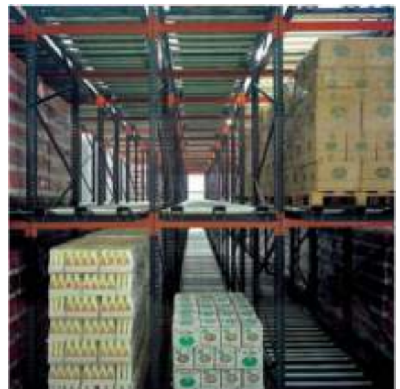
Estantería dinámica motorizada. Permite un almacenaje compacto de paletización y responde al criterio LIFO, se cargan y extraen por el mismo pasillo.
