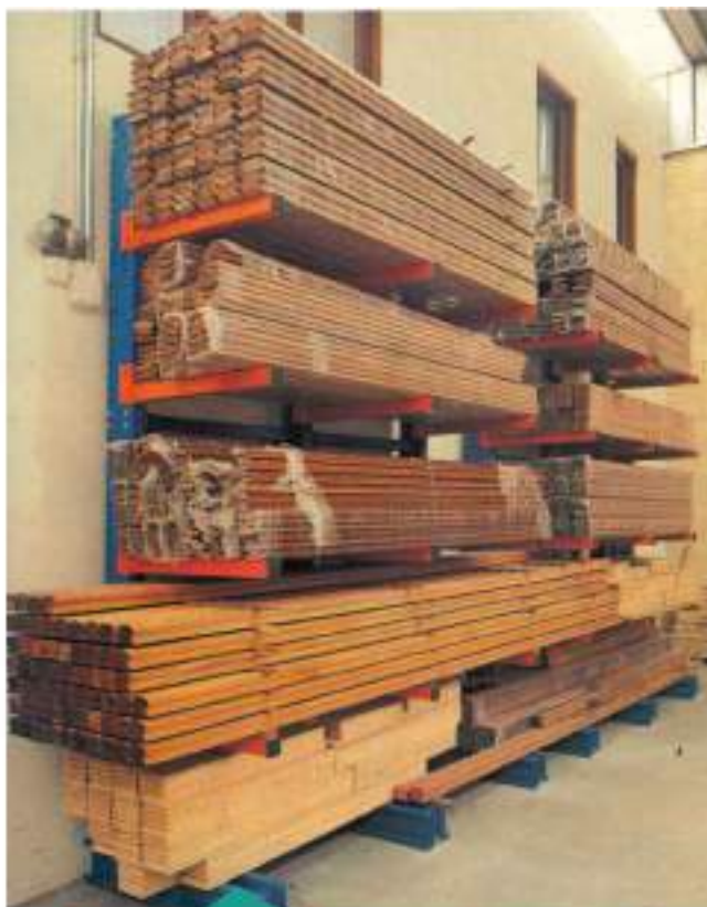
Cantilever simple. Está sujeta a la pared y solo se puede cargar por un lado.
