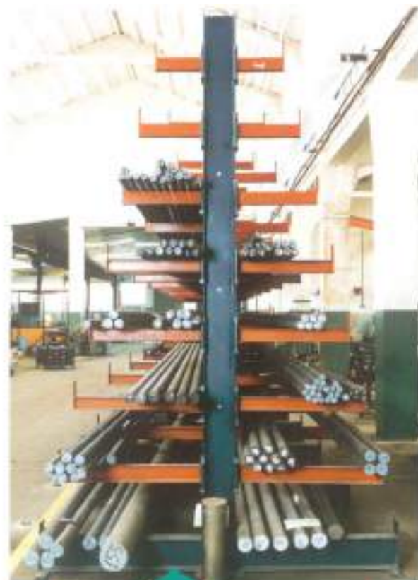
Cantilever doble. Admite carga por ambos lados.
