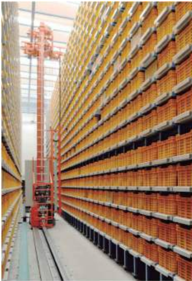
Transelevador con desplazamiento sobre rail guía.
