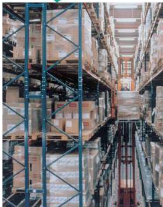
Carretilla trilateral. La preparación de pedidos se hace en todos los niveles de la estantería.
