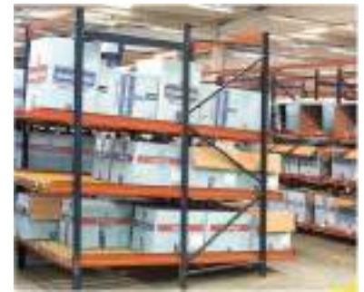
Estantería «drive-through» dinámica por gravedad, responde al criterio FIFO.
