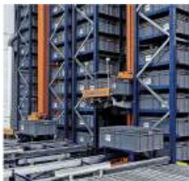
Transelevador, lleva incorporado un lector de código de barras para saber dónde tiene que depositar las cargas. Cortesía de Mecalux.
