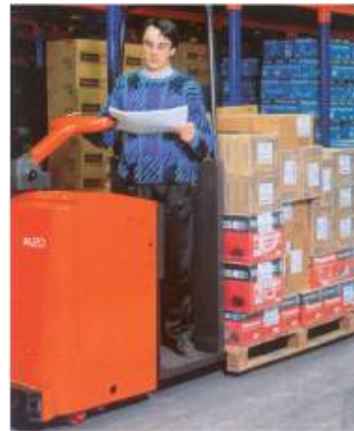
Picking a nivel del suelo utilizando transpaleta eléctrica con hombre montado.
