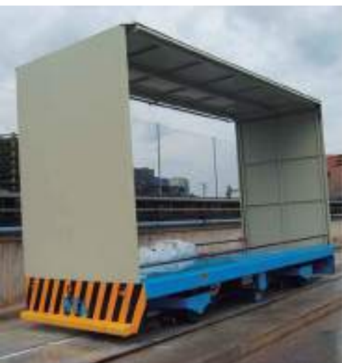
Vehículo filoguiado para mover contenedores de 15 toneladas. Cortesía de Mecalux.
