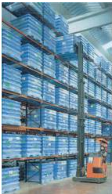
Las estanterías de paletización son las más indicadas para almacenaje de artículos de la Clase «A» o de alta rotación (r).
