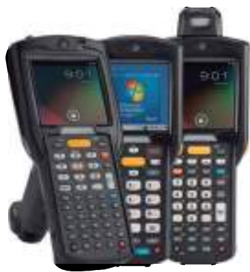
Terminales portátiles para recibir datos de picking , almacenaje, recepción y expedición.
