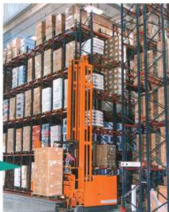
Carretilla trilateral. La preparación de pedidos se hace en todos los niveles de la estantería.
