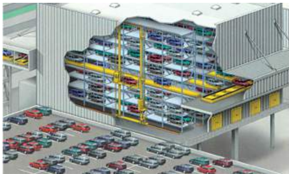
Almacén autoportante para carrocerías. Se pueden almacenar 426 carrocerías, una vez que han pasado el proceso de pintura.
