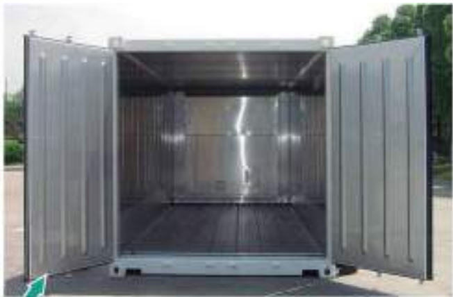
Interior de un contenedor frigorífico.
