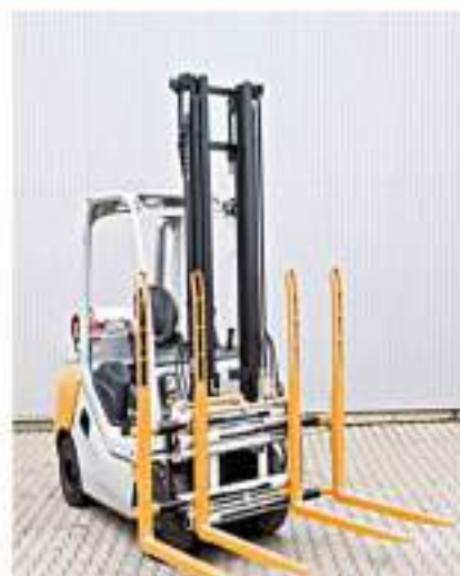
Carretillas con horquillas múltiples, para cargas largas o doble paleta.
