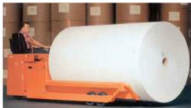
Carretilla con plataforma curva, para el transporte de bobinas de papel y cartón.
