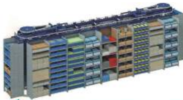
Interior del carrusel. El operario marca el código del artículo, giran los bloques y se abre el armario que contiene dicho artículo.
