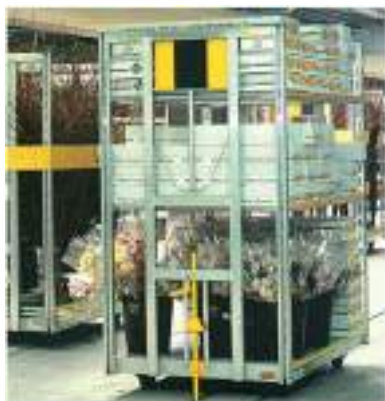
Transportador guiado por cadena subterránea. Lleva las flores a los muelles para su carga en los camiones. Cortesía de EISENMANN.
