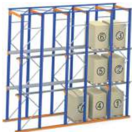
Secuencia de entrada de carga.
