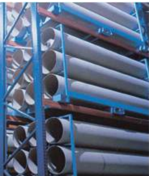
Almacenaje de cargas-jaula de tubos de plástico duro.
