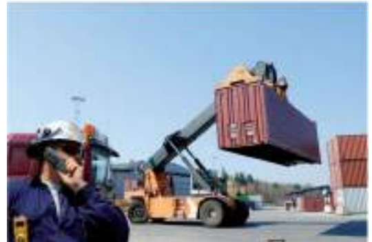
Camión puente, para manipulación de contenedores.
