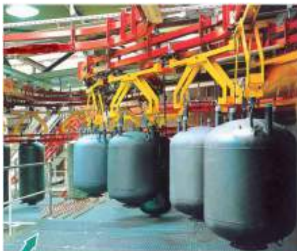
Transportador aéreo para calderas de calefacción.
