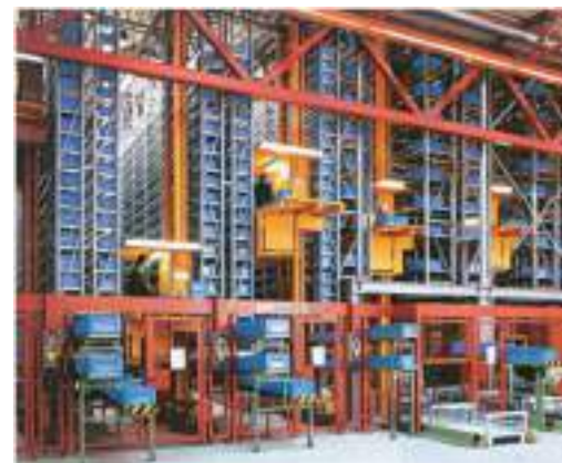
Transelevadores para operaciones de picking . El operario va subido en la cabina y llega a todos los niveles de las estanterías para extraer/depositar los artículos.
