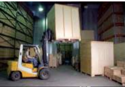
Contenedores de madera apilables y con entrada para las horquillas de los medios de manipulación.
