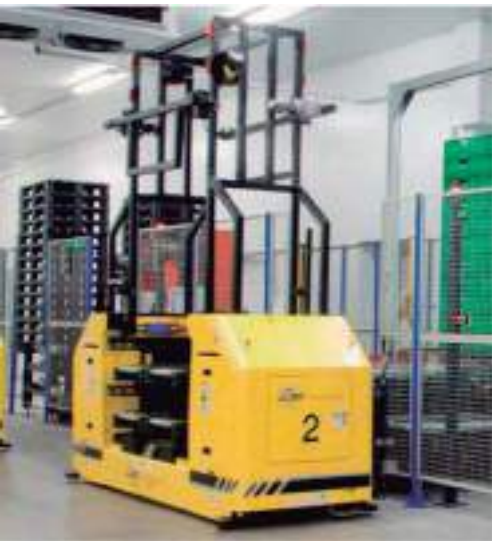
Transportador filoguiado, para cargas y cestos apilados.
