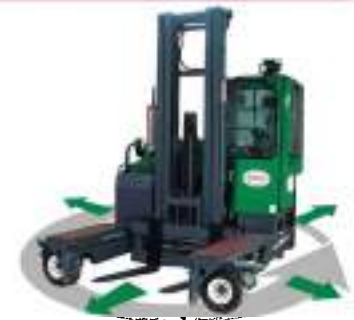
Carretilla de carga lateral y multidireccional para el almacenaje de cargas especiales en estanterías cantilever y pasillos muy estrechos.
