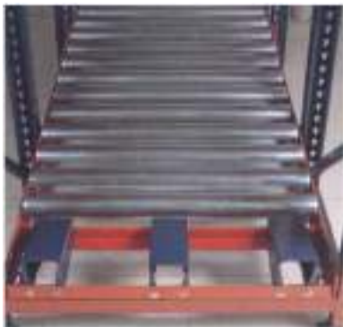
Detalle de un transportador de rodillos. Observa los topes para que no se puedan salir las paletas.
