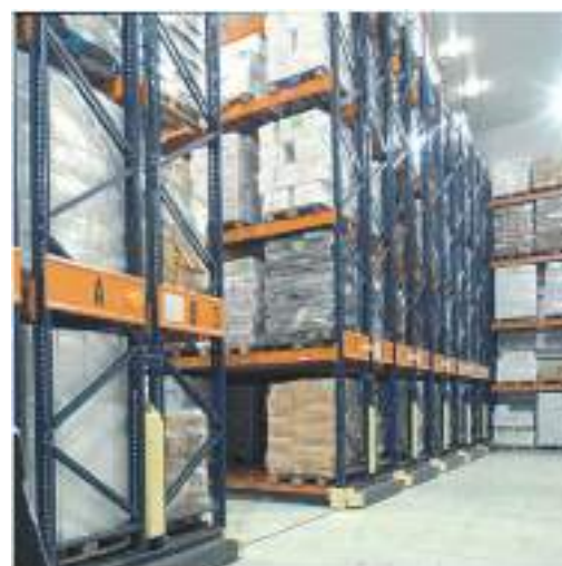
Estanterías colocadas sobre bases móviles guiadas.
